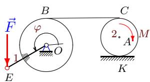
Цилиндр жестко соединен с однородным стержнем массой  $m_1$  длиной  $a$ , к которому приложена вертикальная сила  $F$ . Радиус цилиндра  $R$ . Цилиндр вращается вокруг неподвижной оси и нитью связан с диском массой  $m_2$  радиуса  $r$ . Составить уравнение движения системы. За обобщенную координату принять  $\varphi$ .
