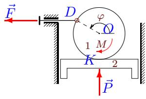
**1.62а.** Цилиндр массой  $m_1$  радиусом  $R$  находится на поверхности поршня массой  $m_2$ . Шток, движущийся в горизонтальных направляющих, шарнирно прикреплен к ободу цилиндра. Момент  $M$  приложен к цилиндуру, сила  $P$  - к поршню,  $F$  - к штоку. Составить уравнение движения системы. За обобщенную координату принять  $\varphi$ .
