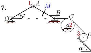
Механизм приводится в движение моментом  $M$ . Кривошип  $OA$  считать невесомым. В шарнире  $A$  сосредоточена масса  $m_1$ . Массы дисков  $C$  и  $D$  —  $m_2$  и  $m_3$ ;  $OA = AB = a$ , массой ползуна  $B$  и стержня  $AB$  пренебречь.
