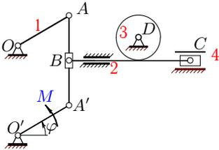
Шарнирный параллелограмм приводится в движение моментом  $M$ . Спарник  $AA'$  считать невесомым, звенья  $OA$  и  $O'A'$  имеют одинаковую массу  $m_1$ . Ползун  $B$  вместе со стержнем  $BC$  имеет массу  $m_2$ , масса диска  $D$  —  $m_3$ , ползуна  $C$  —  $m_4$ ;  $OA = a$ .
