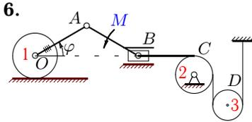
Диск  $O$  радиусом  $R$ , имеющий массу  $m_1$ , соединен с невесомым стержнем  $OA$ . Механизм приводится в движение моментом  $M$ . Массы дисков  $C$  и  $D$  —  $m_2$  и  $m_3$ ,  $OA = AB = a$ , массой ползуна  $B$  и стержня  $AB$  пренебречь.
