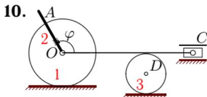
Диск  $O$  радиусом  $R$  массой  $m_1$  соединен с однородным стержнем  $OA = a$  массой  $m_2$ . Масса диска  $D$  —  $m_3$ . Массой ползуна и стержня  $OC$  пренебречь.
