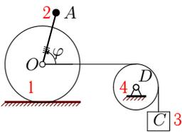
Диск  $O$  радиусом  $R$  массой  $m_1$  соединен с невесомым стержнем  $OA = a$ , на конце которого закреплен груз  $A$  массой  $m_2$ . Груз  $C$  имеет массу  $m_3$ , шкив  $D$  —  $m_4$ .
