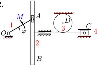
Механизм приводится в движение моментом  $M$ . Ползун  $A$  считать невесомым, кривошип  $OA$  имеет массу  $m_1$ , кулиса  $B$  —  $m_2$ , диск  $D$  —  $m_3$ , ползун  $C$  —  $m_4$ ;  $OA = a$ .
