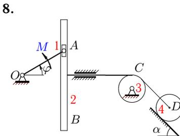
Механизм приводится в движение моментом  $M$ . Кривошип  $OA$  считать невесомым. Ползун  $A$  имеет массу  $m_1$ , кулиса  $B$  —  $m_2$ , массы дисков  $C$  и  $D$  —  $m_3$  и  $m_4$ ;  $OA = a$ .
